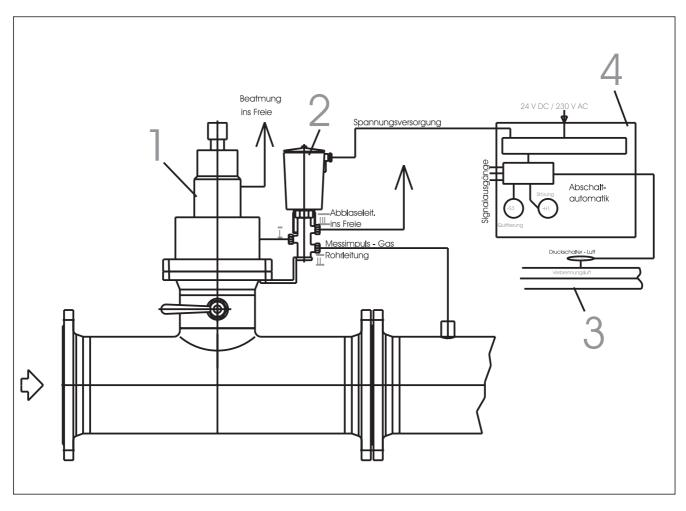
Für Industrie-Brenneranlagen wird oftmals neben der Überwachung des Gasdruckes auch eine Absicherung des Luftdruckes (Verbrennungsluft) gefordert.
