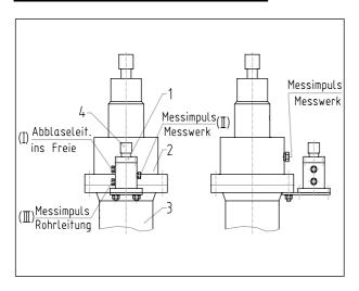
Für die mechanische Handauslösung (Hand-Notaus) kann ein 3/2-Wege-Tastventil 1 an das Stellantriebs-Gehäuse 3 angebaut werden.
