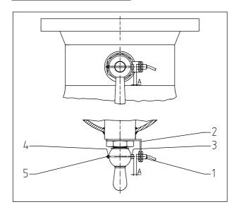
Für die elektronische Fernanzeige der SAV-Ventilstellung kann ein induktiv wirkender Sensor an das Stellantriebs-Gehäuse montiert werden.
