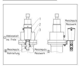
Für die elektronische Fernauslösung kann ein 3/2-Wege-Magnetventil 1 an das Stellantriebs-Gehäuse 3 angebaut werden.
